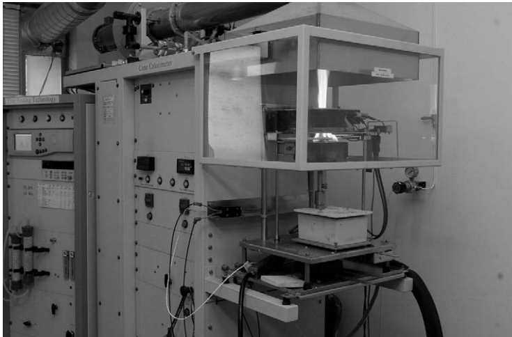
그림1. KS F ISO 5660-1 시험장비 : Cone Calorimeter
