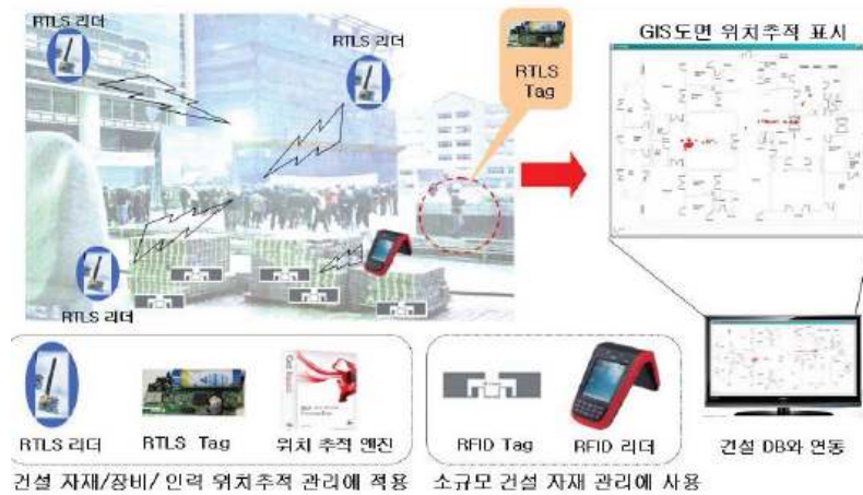
<건설현장용 RTLS 시스템 개념도, 자료 : LS산전>
