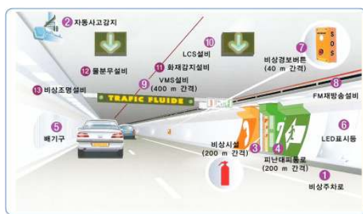
프랑스 A 86 동터널 방재설계도 (2010한국터널공학회 터널기술토론회 자료집)
