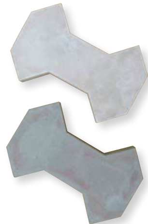
3. 한국건설기술연구원에 있는 생태연못에 물고기집을 시범 시공하는 모습 4. 류금성 박사는 사용자 입장에서 다양한 시험시공을 통해 문제점을 발견하고 개선해오만 기술 이전에 성공할 수 있다고 말했다. 5. 무시멘트 기술을 적용해 제작된 콘크리트 시제품
