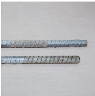
FRP Hybrid Bar 표면의 유리강화섬유는 인장성능 향상 및 부식 방지 역할을 수행한다.
