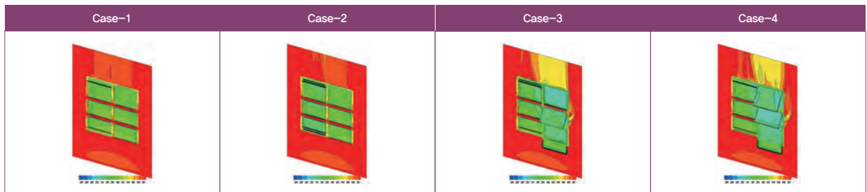
그림 4 — 다기능 수퍼윈도우시스템의 열유동 분포
