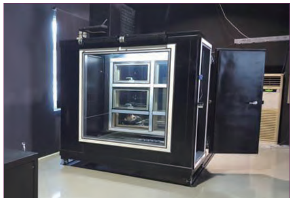
그림 3 — KS L 9107에 의한 태양열취득률(SHGC) 시험
