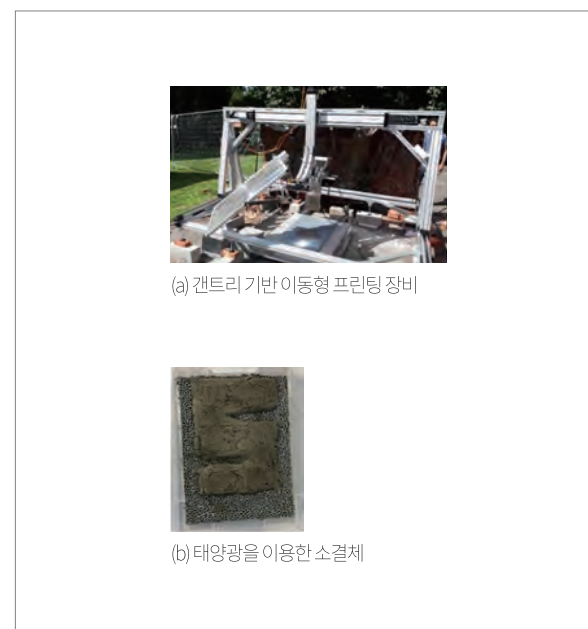
[그림 5] 태양광을 이용한 인공월면토 소결 기술
