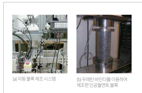
[그림 3] 고분자 바인더를 활용해 제조한 인공월면토 블록
