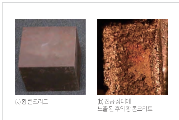
[그림 2] 황을 바인더로 활용해 제조한 황 콘크리트
