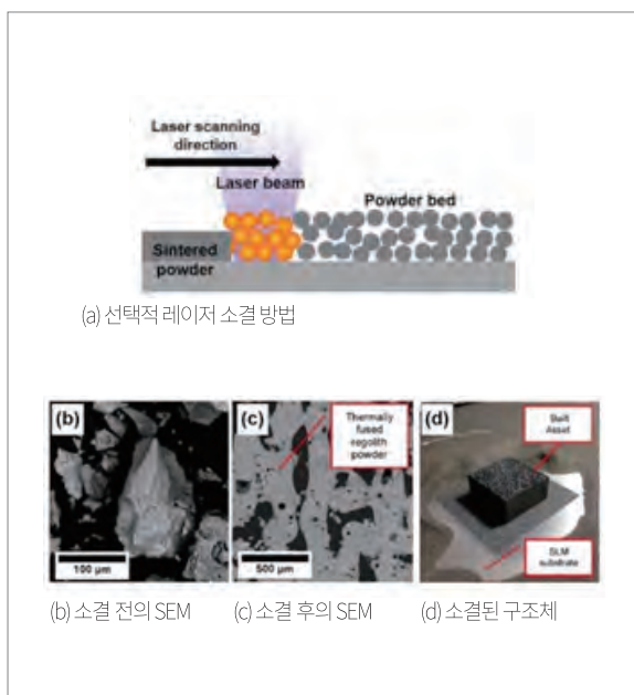
[그림 4] 레이저를 이용한 인공월면토 소결 기술
