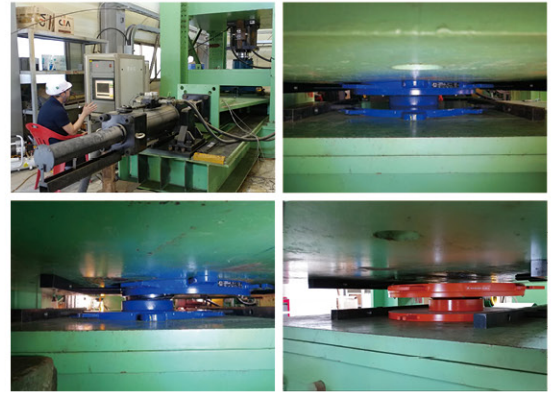
그림 11. 지진격리받침 성능평가 시험(마찰형)
