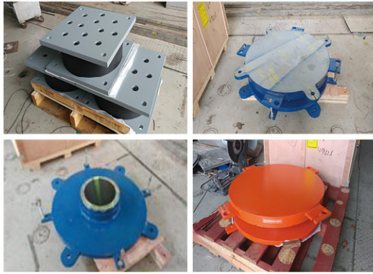
그림 10. 고무형, 마찰형 지진격리받침 시험체
