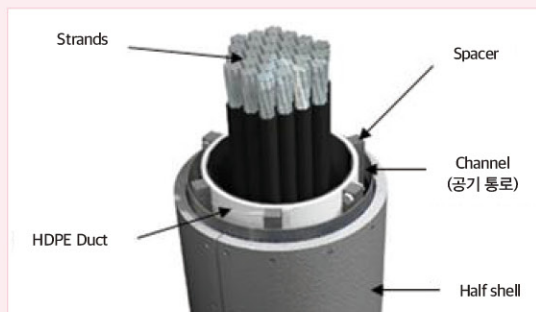
그림 2. 기존 케이블 내화 보강방법
