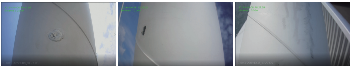
그림 5 케이블 점검 로봇 영상촬영(외관조사) 성능
