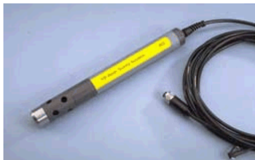
(c) 수위, pH, EC, DO 및 각종 수질 관측 장비
