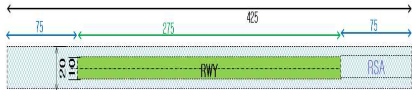
그림 11. 활주로 양쪽에 안전구역을 설치한 활주로 평면도
