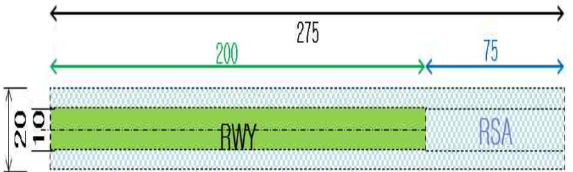
그림 20. 활주로 시단 한쪽에 안전구역을 설치한 활주로 평면도
