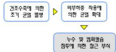
그림 1.2 장경간 RC 시스템의 하부 균열에 의한 누수
