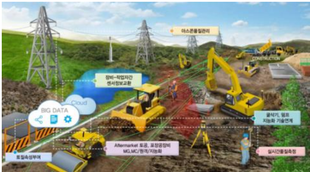
그림 4.3 디지털 기반 SOC 도로 건설장비 자동화 개념도
