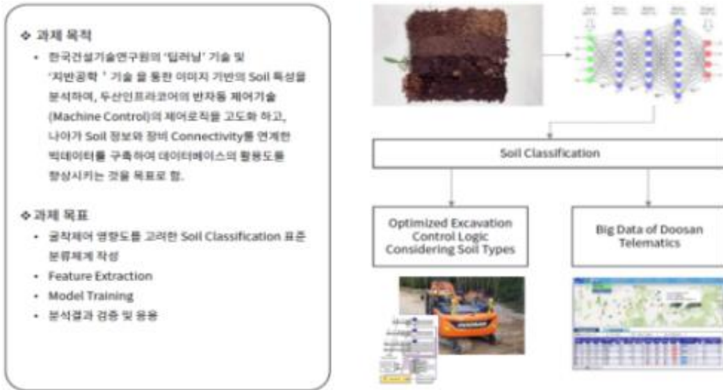
[ “AI 기반 Soil Classification 정보를 활용한 굴삭 제어기술 고도화” 과제 개요도(안)]
