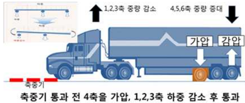
그림2.2 과적 단속검문소에서의 화물자동차 축조작 개념
