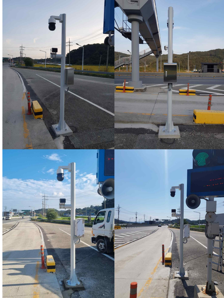
그림3.22 속도측정 기준장치 및 참고영상(CCTV) 거치
