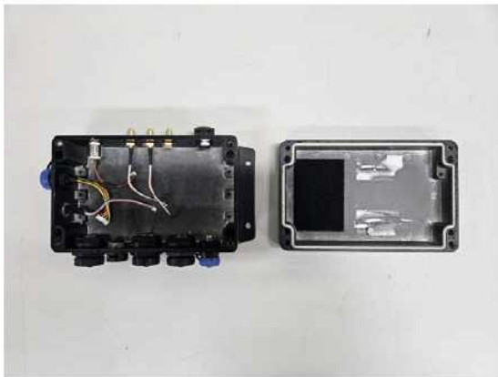
그림 3.16 IP65 시험 후 시험품 사진
