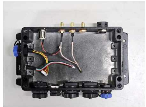
그림 3.16 IP65 시험 후 시험품 사진
