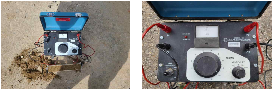
그림 3.15 측정기를 활용한 토양비저항 측정
