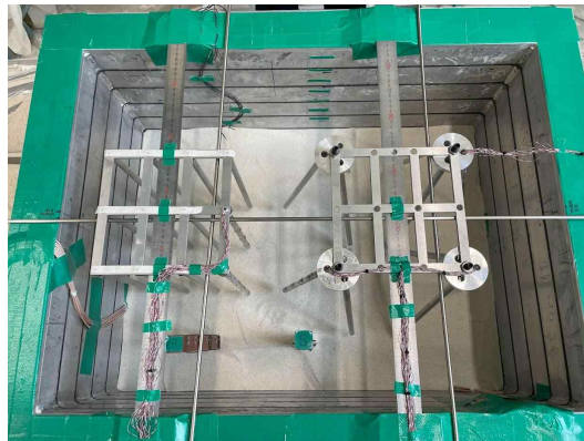
그림 3.4 그룹 삼축내진말뚝 설치 및 낙사 모습
