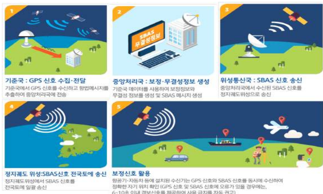
[ 그림 6. KASS 시스템의 원리 ]
